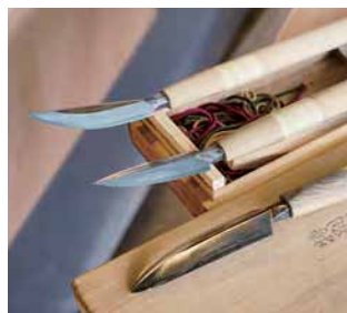
奈良時代の建材の表面加工を再現するために復原された槍鉋(やりがんな)
