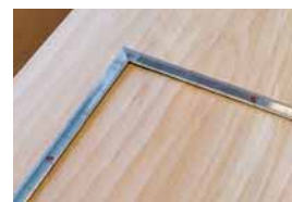
奈良時代の尺を再現した指矩(さしがね)と槍鉋(やりがんな)で加工した木材表面
